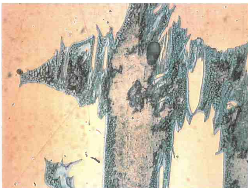
Figura 22: Micrografia de fases metaestáveis (fase escura) na amostra CAD CONG e aumento de 1000X.
