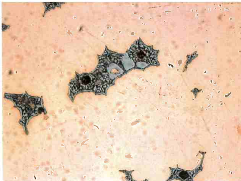
Figura 21: Micrografia de fases metaestáveis da amostra AR FORTE CONG com aumento de 1000X.
