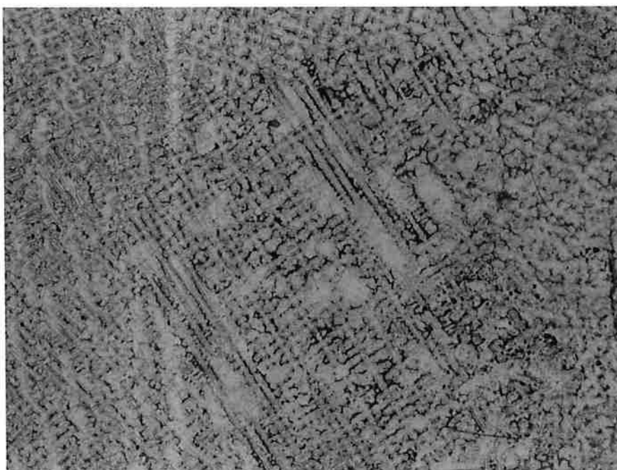
Figura 19: Dendritas equiaxiais da amostra AR FORTE com aumento de 50X
